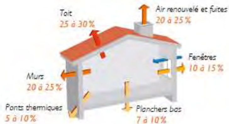
Pertes de chaleur d'une maison moderne non isolée Source : ADEME
